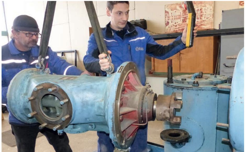
Die zentnerschwere Verdichterstufe eines Kompressors wird von Florian Kattowitz (rechts) und Thomas Groppe überholt.
