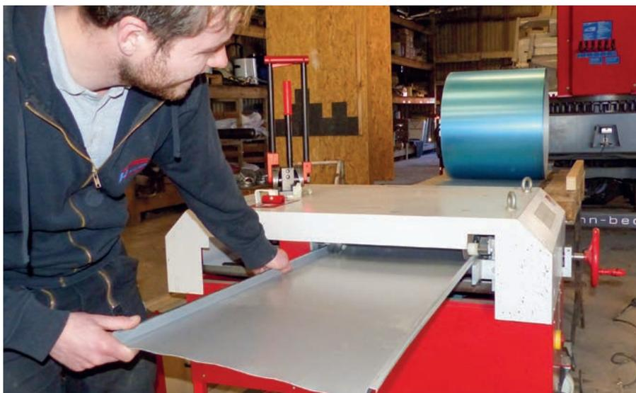
An der Profilmaschine lässt Johannes Hartmann absolut passgenaue Falze der Metallpaneele entstehen.
