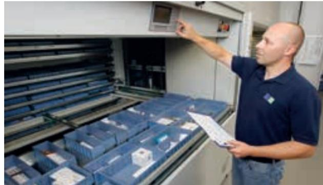
Zur Optimierung der Intralogistik hat die Primus Präzisionstechnik GmbH & Co KG ein automatisches Lagersystem mit insgesamt fünf großen Lagertürmen installiert – das hier von Facharbeiter Björn Wille bedient wird.
