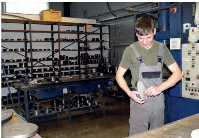
Bereits am Rohling ist Handarbeit fällig: Auf die Scheibe wird später die Schleifkörnung gepresst.
