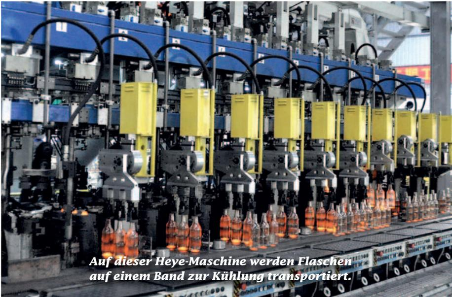
Auf dieser Heye-Maschine werden Flaschen auf einem Band zur Kühlung transportiert.
