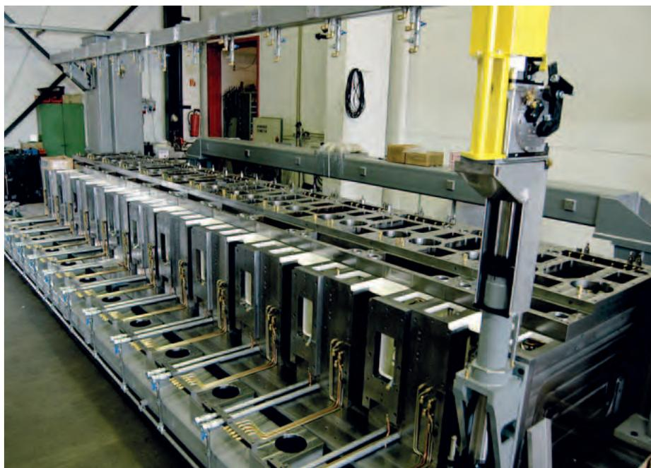
*Bis zu 500 Flaschen pro Minute formt diese Anlage. Gebaut wird sie für eine Glashütte in der Türkei.*
