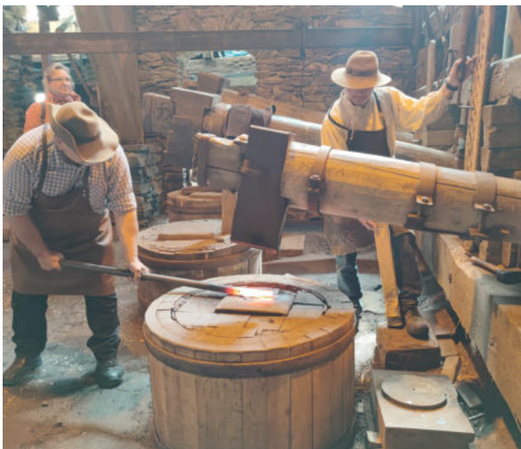
Abb. Der Frohnauer Hammer in Betrieb
