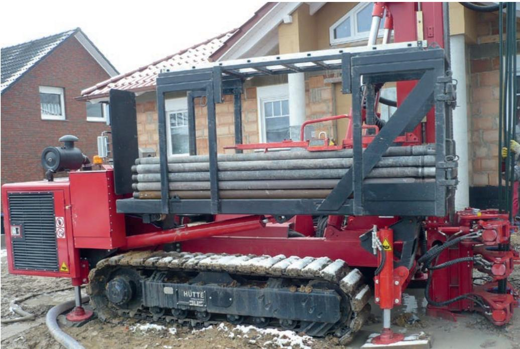
*Um die Erdwärme zu nutzen, müssen Sonden in den Boden gebohrt werden.*
